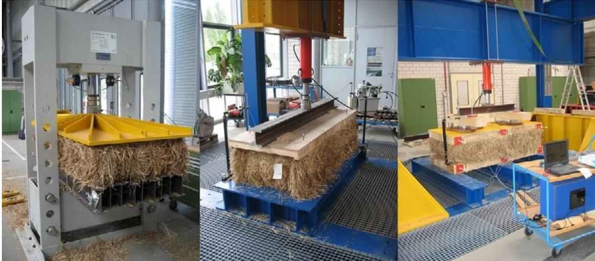
Figure 28 Essai de relaxation sur bottes séparées - De gauche à droite: botte n°13 avec  $\epsilon_0= 10\%$ , la botte n°9 avec  $\epsilon_0= 20\%$  et la botte n°10,  $\epsilon_0= 30\%$  (Source Danielewicz et al. (2008))
