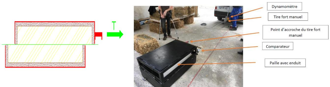
Figure 21 Principe de l'essai de cisaillement sur bottes - Boîte de cisaillement (IUT de Nîmes, 2019)
