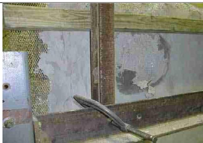
Figure 27 Face arrière du tir IV avec effritement de gros morceaux d'enduit au niveau de l'impact sur la face arrière sans impact sur le grillage en métal déployé (Source : Billelo (1999))
