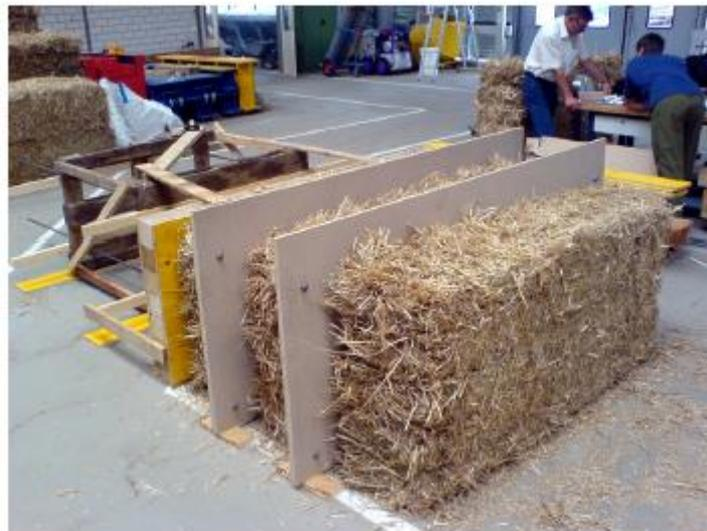
Figure 32 Précompression du mur couché à plat (Source : Danielewicz et al. (2008))
