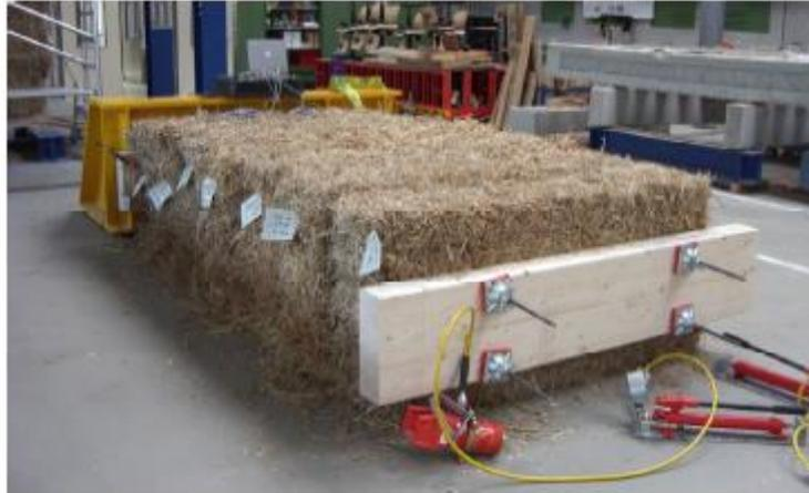
Figure 34 Précompression du mur couché à plat (Source : Danielewicz et al. (2008))
