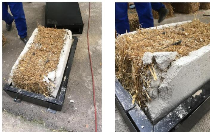
Figure 22 Fissuration de la botte 2 après essai
