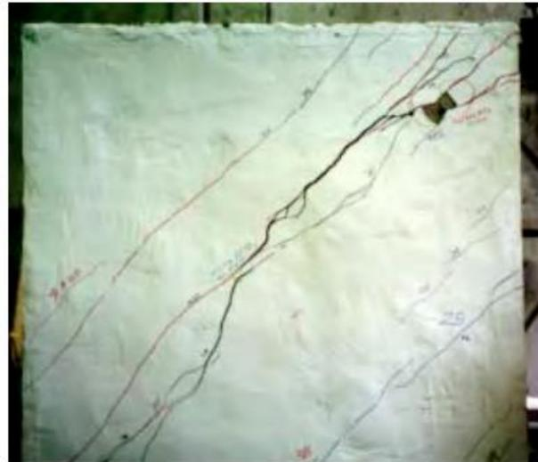
Figure 13 Deuxième essai en cisaillement avant le décrochage du dynamomètre (Source : Nichols et Raap (2000))
