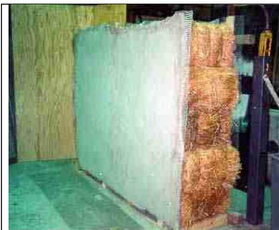
Figure 26 Mur enduit et renforcé par du grillage
